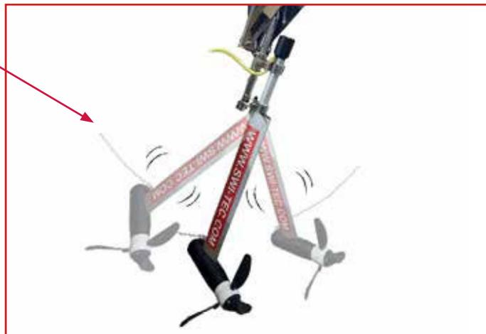
Am Segment kann durch verschiedene Bohrungen die Neigung vom Spiegel (auch bei Negativspiegel) so eingestellt werden, dass der Hydro Charger Light in vertikaler Position im Wasser steht. (Bild)
